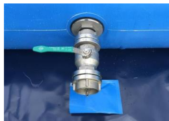
Befüll- und Entnahmearmatur
