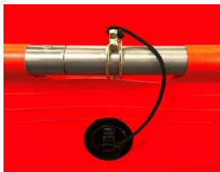
Sicherung durch Rohrklappstecker
