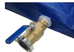
Befüll- und Entleerungsarmatur mittig an einer Stirnseite 2" Kugelhahn mit C-Storz Festkupplung und ggf. Blinddeckel
